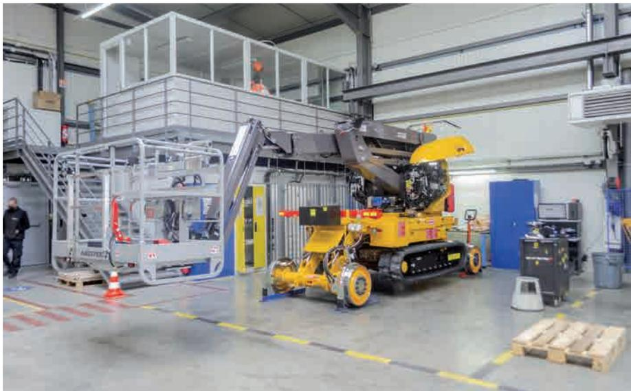
**La Sky C14 est la première nacelle rail-route 100 % Néotec. Elle dispose d'un moteur diesel STAGE V et d'un bras spécialement conçu pour travailler en évitant toute interférence avec les systèmes de réseaux caténaires.**
